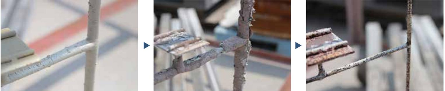
当社では熱処理、ショットブラスト、バレル研磨機を用いてハンガーなどに付着した塗装を剥離しています。リムーバーなどの薬品は使用していません。
